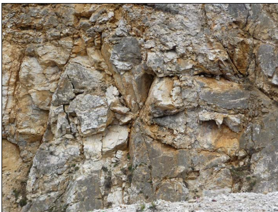
Slika 11. Rastreseni površinski dio i prijelazni dio gornje trijaskih vapnenaca
